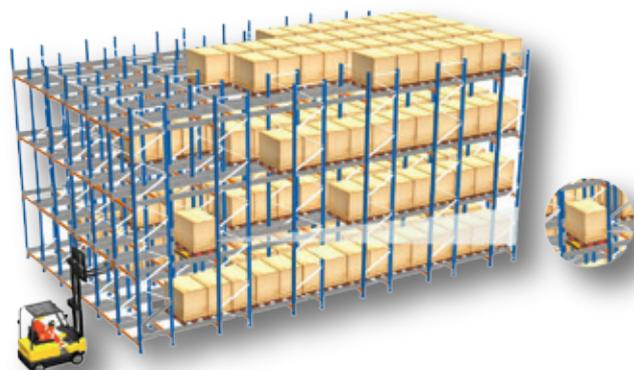
Multi deep regalni sustav predstavlja regalni sustav izveden iz drive-in regala gdje se palete postavljaju jedna iznad druge na specijalne nosače u tunele, a odvoz paleta u dubinu tunela odvija se pomoću posebnog uređaja shuttle-a.
