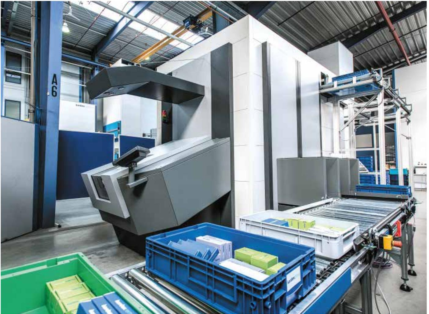
Kardex VBM (Vertical Buffer Module) sastoji se od dvije paralelne kolone s policama (poličnih regala) na kojima se skladišti roba, središnjeg prolaza za robota (automatske dizalice = pokretnog jarbola) koji vrši odlaganje, izuzimanje i transport kutija, panela i jedne ili više radnih jedinica.
