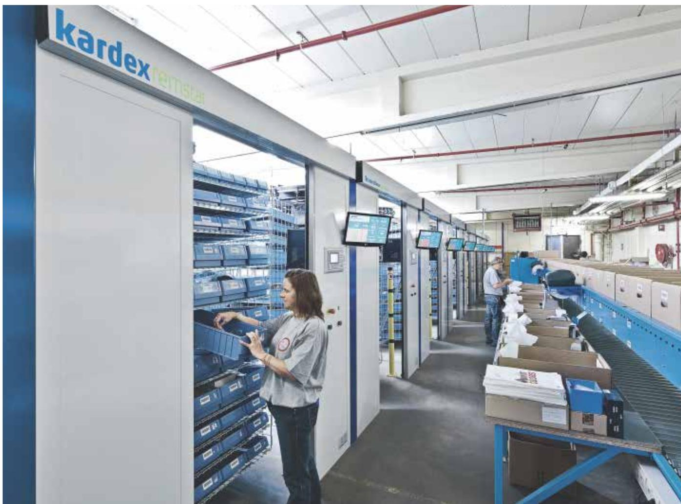
Modularna izvedba uređaja omogućuje prilagodbu prostoru odnosno robi tj. potrebnom kapacitetu. Horizontalni karusel sastoji se od regalnih polja, koja rotiraju u horizontalnoj ravnini i koja su preko zglobnog ramena međusobno povezana, tako da predstavljaju "beskonačni" lanac. Pomoću elektromotora regalna polja se pomiču naprijed ili nazad do stanice sa poslužiteljem. Regalna polja zatvorena su sa tri strane žičanim rešetkama i imaju određeni broj polica.
