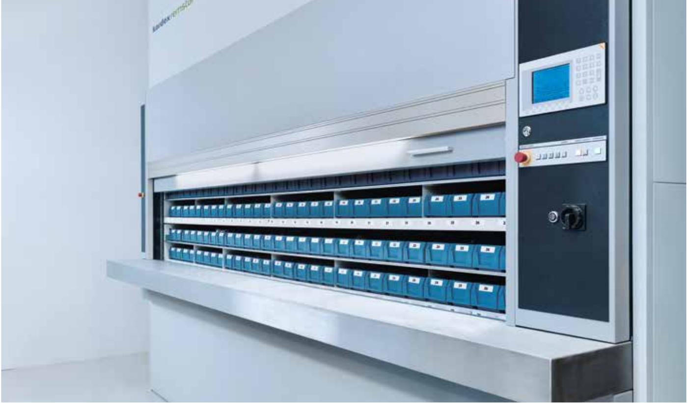
Okretni regal se može integrirati neposredno u proizvodni sustav, s ciljem skladištenja prema proizvodnim ili montažnim skupinama, ili u skladište odnosno distributivne centre. Kod izmijenjenih uvjeta moguće je uređaj rastaviti i preseliti na novu lokaciju i prilagoditi novim zahtjevima.
