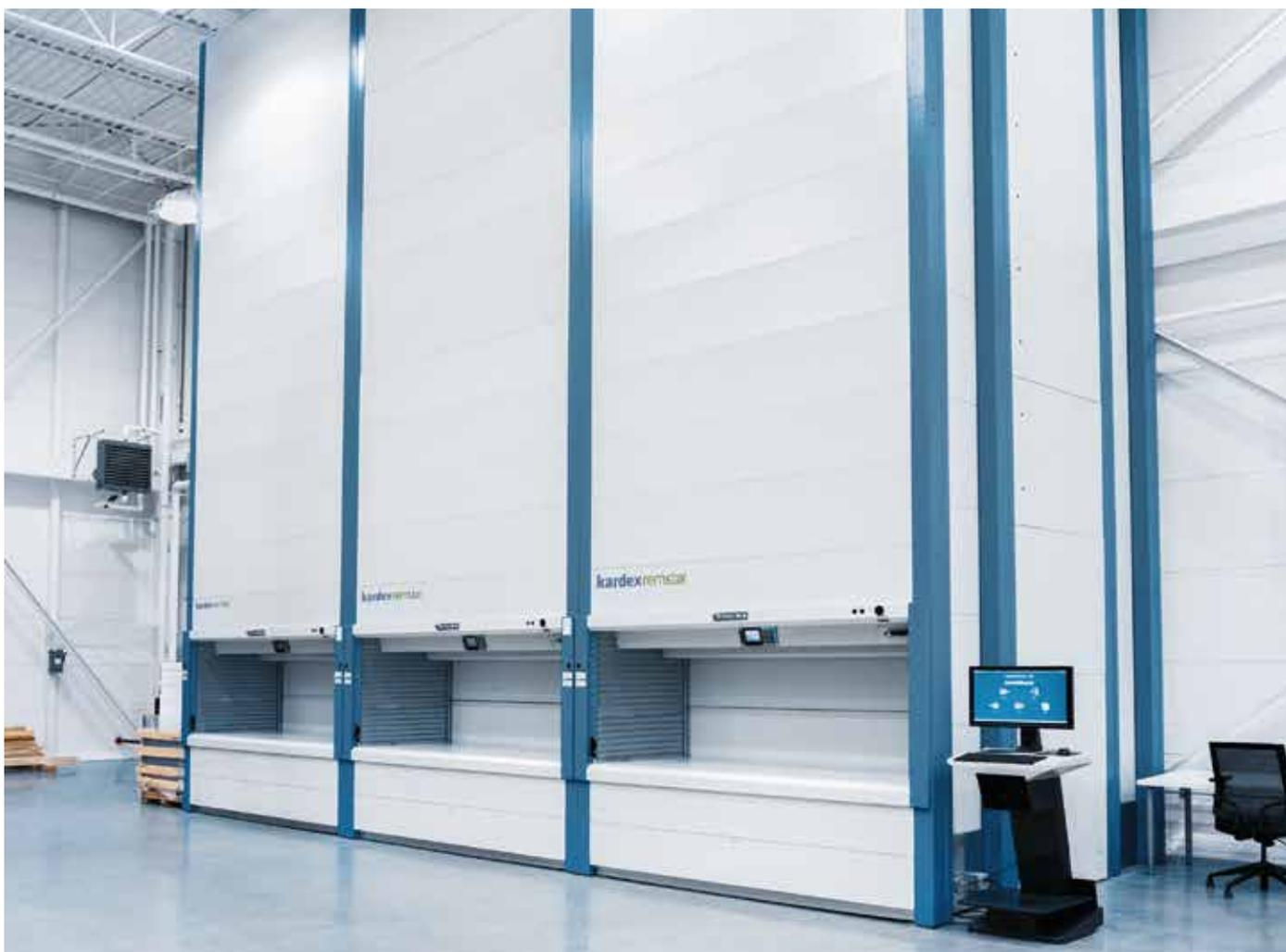
Uređaji koriste raspoloživi prostor od poda do stropa što omogućuje uštedu do 85 % površine „skladišta“. Modularni način gradnje omogućuje prilagodbu svakoj visini do 30 m s visinskim korakom od 100 mm. Pristup robi je jednostavan i brz na ergonomski definiranom radnom otvoru.
